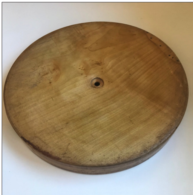
Dispositif permettant la fixation d'un résonateur. Celui-ci est un 'close fit resonator' qui se pose contre le 'rim', en l'absence d'un 'flange'. Il laissera une trace sur le dowel stick .
