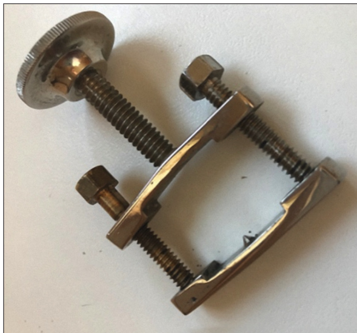
Dispositif permettant la fixation d'un résonateur. Celui-ci est un 'close fit resonator' qui se pose contre le 'rim', en l'absence d'un 'flange'. Il laissera une trace sur le dowel stick .
